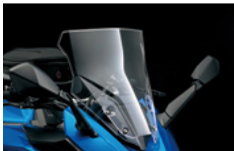
Szyba turystyczna 94600-48890-000 Znacząco redukuje nacisk wywoływany pędem powietrza na górną część ciała i głowę kierowcy. Wyższa o 77 mm od wersji standardowej.
